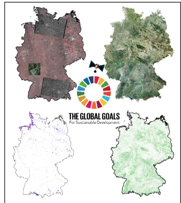
Abb. 2: Oben links: zwei Ausschnitte von Sentinel-1 von 2017 und ein Sentinel-2 Ausschnitt von 2018 auf einem Sentinel-1 VV-Mosaik von Deutschland vom Juni 2016; oben rechts: Farbmosaik von Deutschland basierend auf Sentinel-2 von 2018; unten links: High Resolution Layer: Water and Wetness (SDG Indikator 6.6.1); unten rechts: High Resolution Layer: Forest type (Indikator 15.1.1). (Quellen: Vereinte Nationen (SDG-Logo) bzw. Europäische Union, beinhaltet veränderte Copernicus Sentinel Daten 2016-2018 und Daten des Copernicus Dienst zur Landüberwachung 2015, verarbeitet durch BKG)
