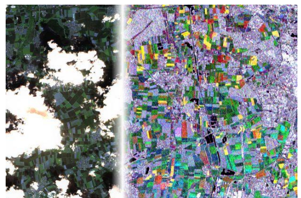
Abb. 1: Satellitenbilder über Braunschweig: Sentinel-2 Echtfarb-Komposit (links) und Sentinel-1 Falschfarben-Komposit (rechts). (© ESA Copernicus Open Access Hub: https://scihub.copernicus.eu/dhus/#/home )
