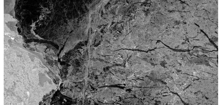
Erkennung von Presseisrücken (3m) durch TerraSAR-X zur Unterstützung der Schiffsnavigation
